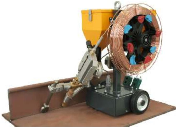
Особенность сварочного автомата UPK это одноосное шасси, чем самым достигается его малый вес. Устойчивость обеспечивается третьим, опорным колесом, которое устанавливается бесступенчатым образом и ведет автомат точно вдоль углового сварочного шва. Паз колеса обеспечивает надежное перемещение по местам прихватки.
