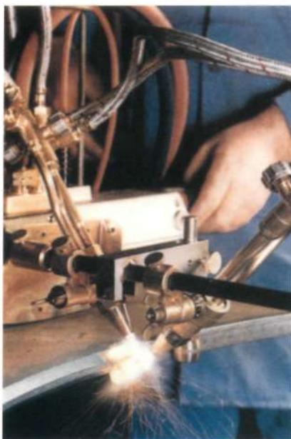
Фото 8. Quicky-E с дополнительным устройством и ведущим роликом для К-образных резов
