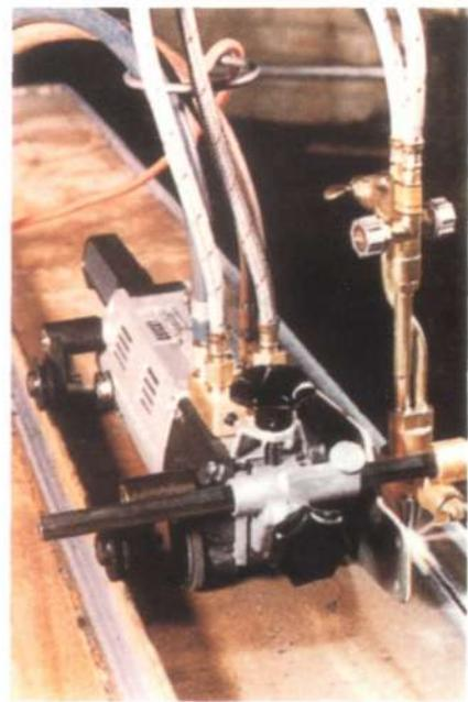
Фото 3. Автоматическая прямолинейная резка с боковыми направляющими роликами на угловых профилях
